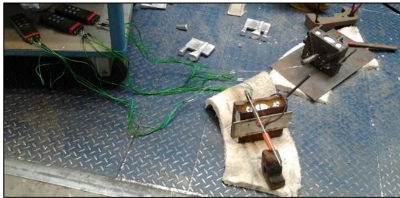
34. ábra A kísérleti elrendezés a két öntőformával és az adatgyűjtőkkel
