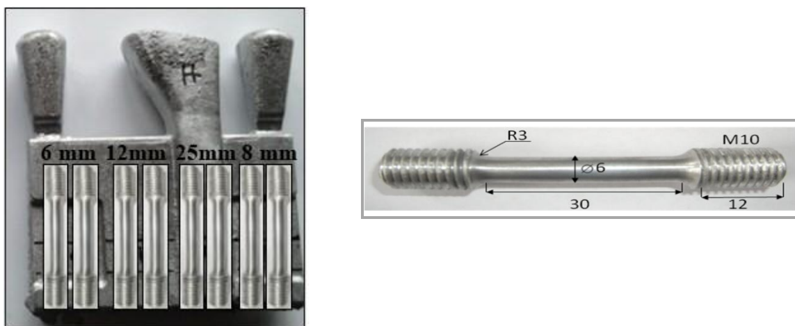
37. ábra A szakítópálcák kimunkálási helyei és méretei
