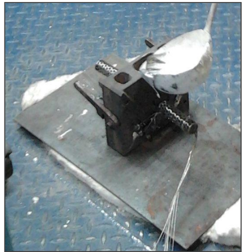
32. ábra A kézi kokilla tervrajza és a kész kokilla öntés közben
