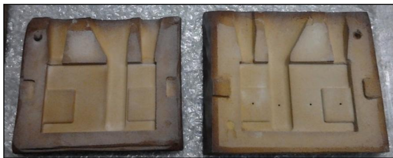
33. ábra A héjhomokból készített homokforma
