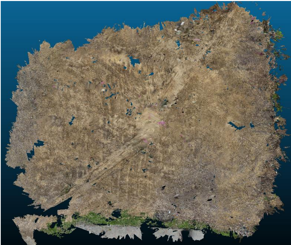
12. ábra: Tereprendezés után LiDAR-ral felmért 3D-s modell felülnézeti képe. (szerző saját szerkesztése)
