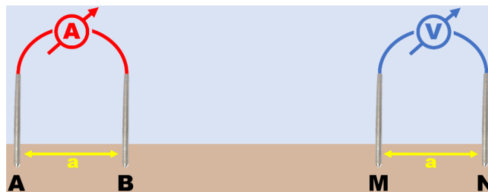
4. ábra: Dipól-dipól elrendezés (A-B: adó elektródák, M-N: vevő elektródák) (szerző saját szerkesztése)
