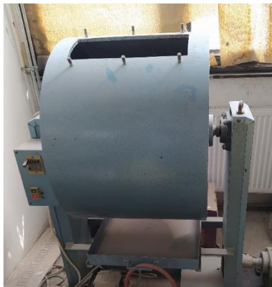
155. ábra: MSZ EN 1097-2 szabvány szerinti Los-Angeles vizsgálóberendezés (Szerző saját felvétele)
