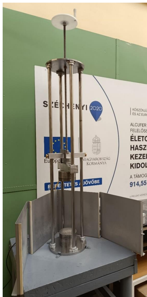
18. ábra: Esősúlyos berendezés második, továbbfejlesztett konstrukciója
