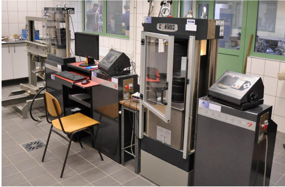
157. ábra: Controls gyártmányú 3000 kN-os nyomógép (jobb oldalt) (Kép forrása: https://bei.uni-miskolc.hu/labo-rok )
