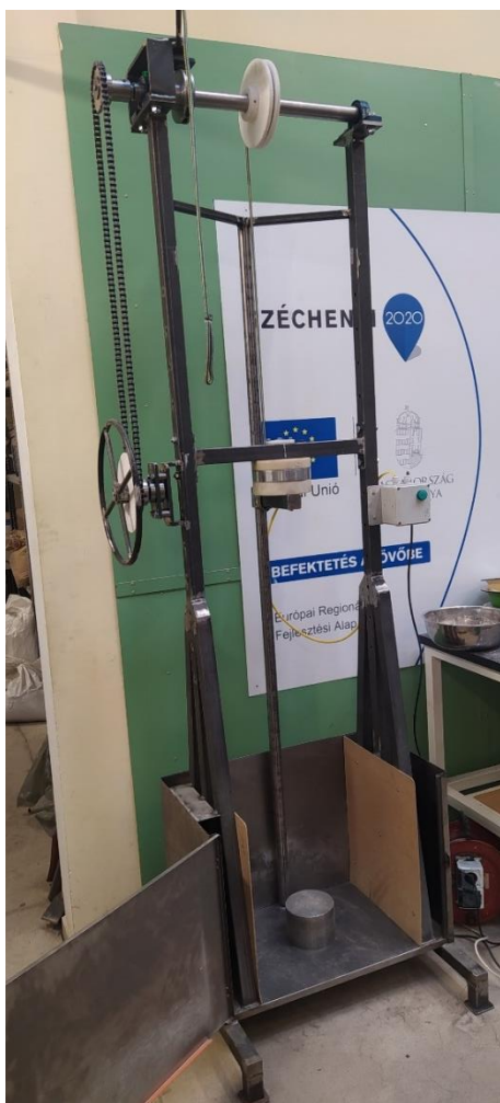
17. ábra: Esősúlyos berendezés első konstrukciója
