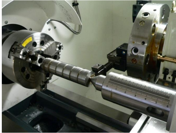
2.5. ábra. A munkadarab és szerszám elhelyezkedése a munkatérben
