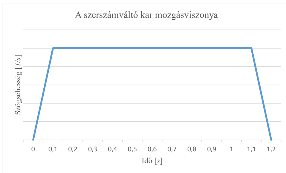
19. ábra. A szerszámváltó kar mozgásviszonya egy csereperiódus alkalmával
