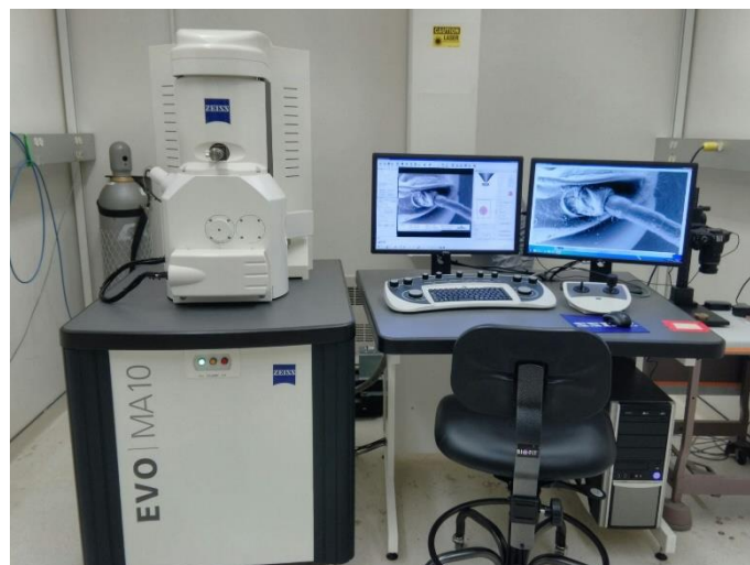
62. ábra, Zeiss EVO MA 10 típusú SEM berendezés
