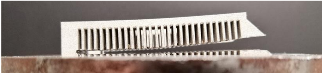
26. ábra, Maradó feszültség mérő próbatest tárgyasztaltól való vágása során kialakuló maradó alakváltozás
