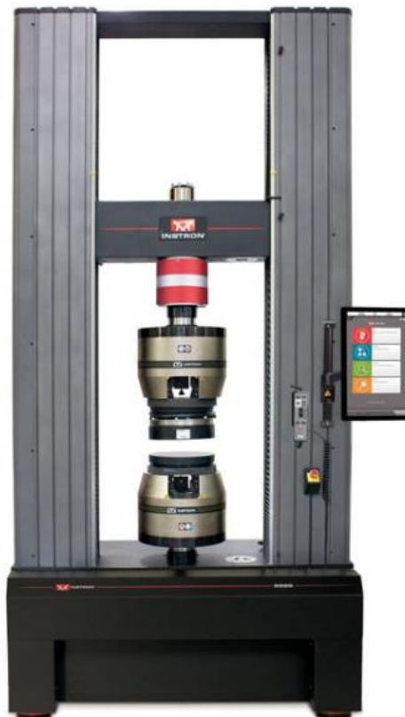
42. ábra, Instron 5980-as szériájú szakítógép
