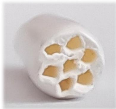
4.2. ábra: SevenBore membránszál keresztmetszeti képe [saját kép]
