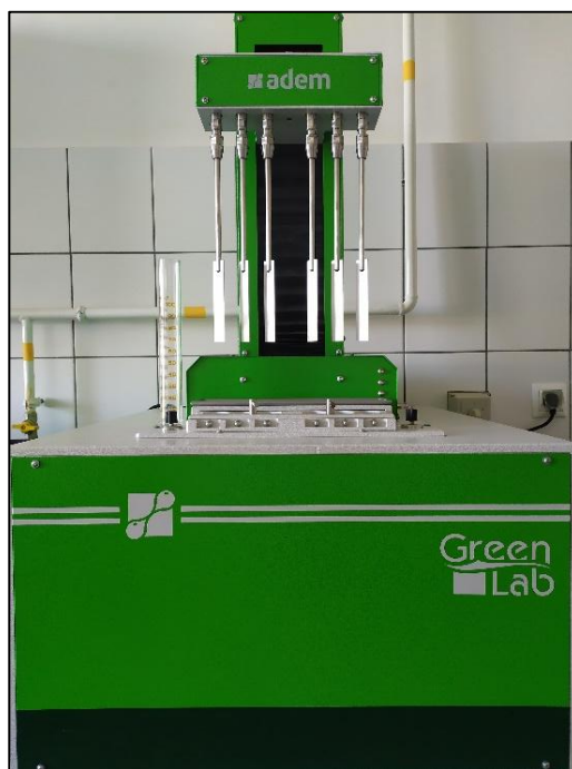
5.1. ábra Az emulgeáló hatás vizsgálat módszerfejlesztéséhez alkalmazott automata emulgeáló berendezés [143]
