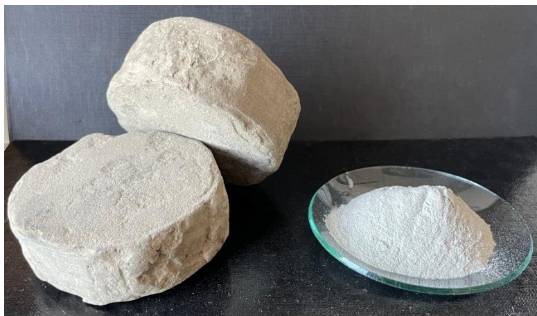
3.1. Kőzetmag és az abból készült porított kőzet
