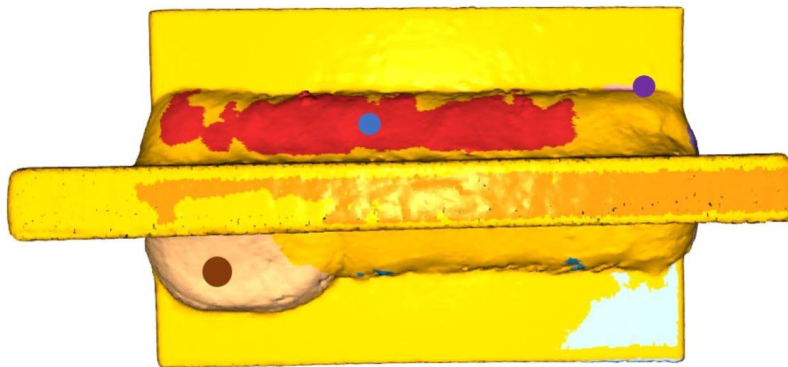
48. ábra Túlzott konvexitási hiba a tömegközéppontokkal felülnézetből. A piros index kívül esik a tűrés (3 mm) B kategórián, a jelölőpontok színei a 49. ábrához illeszkednek.
