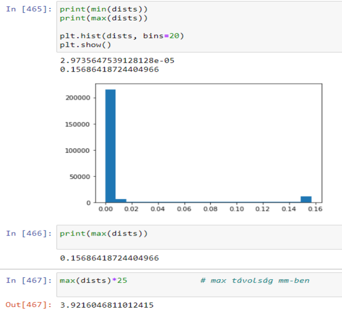
38. ábra Pontok távolságának (x-tengely) és azok számának (y- tengely) egyezése nagyobb gyökér hiba ok esetén
