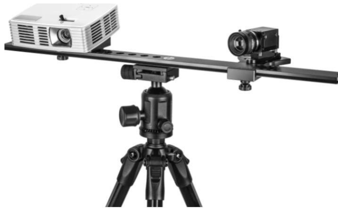
14. ábra A HP strukturált fény szkennelőkészlet [111]
