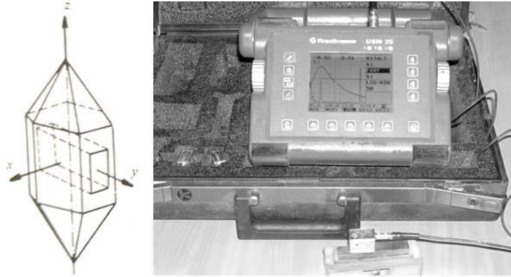
6. ábra Piezoelektromos kvarckristály (a), ultrahangos vizsgáló berendezés és vizsgáló fej (b) [86]
