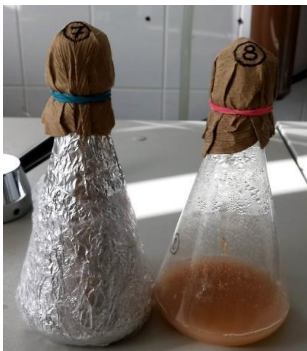
3.4.7 ábra: rázott lombikok, balra a teljes sötétséget biztosító csomagolással ellátott lombik
