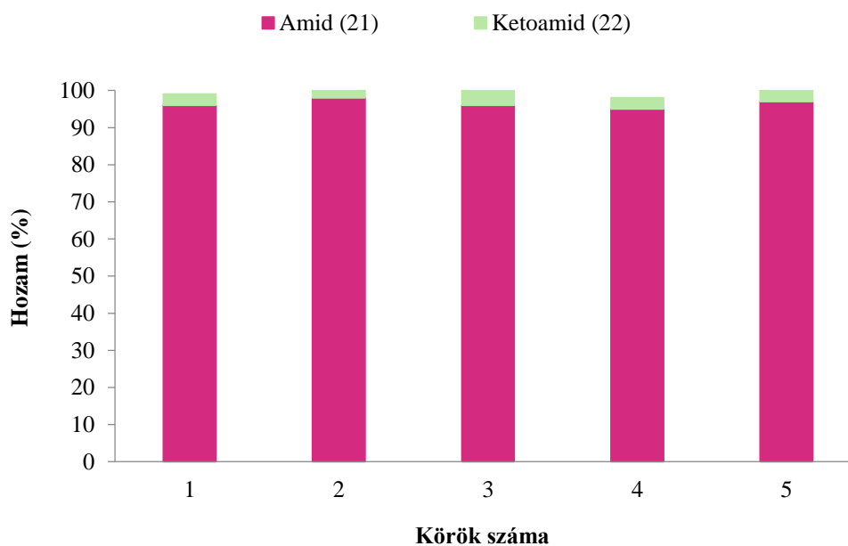
2.9. ábra: CAT-6 katalizátor visszaforgatásakor nyert eredmények nikethamide ( 21 ) előállításánál (a hozamot gázkromatográfiásan határoztam meg)
