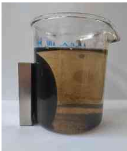
9. ábra: Mágnesezhető részecskék elválasztása mágnes segítségével
