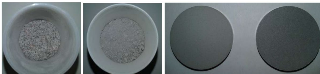
8. ábra: őrölt beton minták és a belőlük XRF mérésekhez készült pelletek [46]
