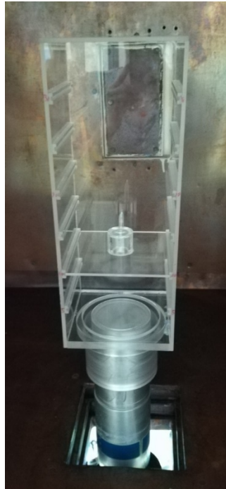
7. ábra: Az NAA során használt alacsony háttérű mérőkamra benne egy beton mintával (saját kép)
