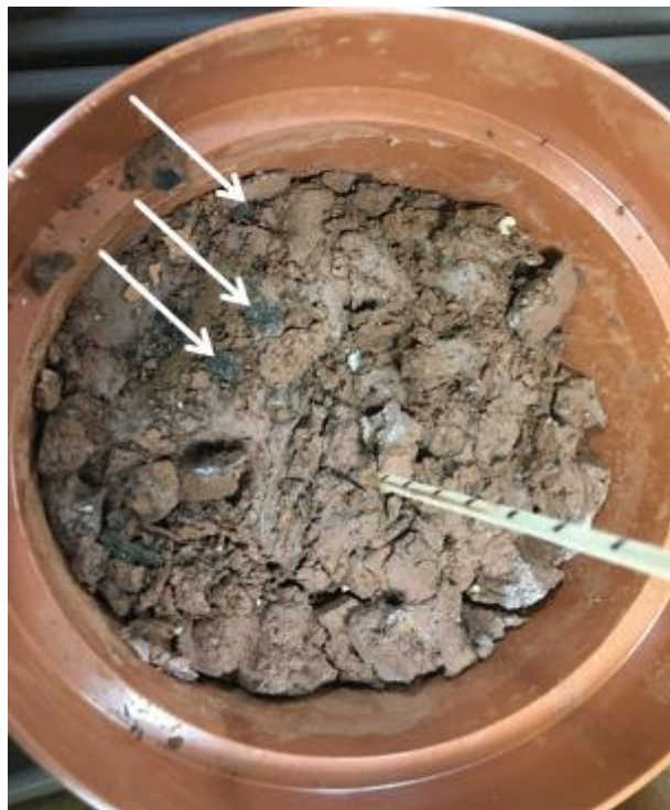
18. ábra: A vörösiszapot tartalmazó talajmátrix inhomogenitása. Jól kivehetőek a virágföldet tartalmazó göbök
