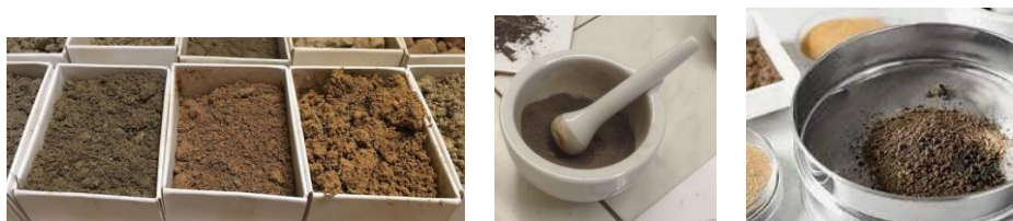
6. ábra Talajminták szárítása, szitálása és porrá őrlése
