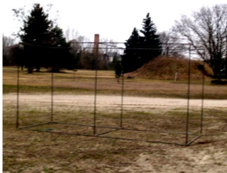
2., 3. ábra, 1., 2. kép: 15 perc alatt összeállítható kalibráló ketrec
