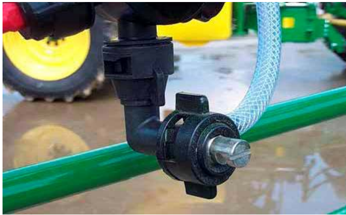
1. sz. ábra: TwinFluid szórófej felépítése és rögzítése
