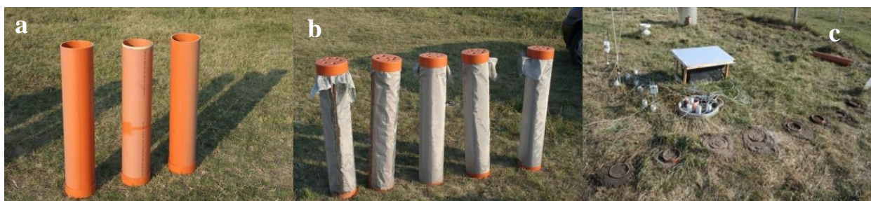
3. kép: A particionáláshoz használt zárt PVC csövek (a), mikropórusú inox hálóval borított PVC csövek, (b), talajhengerek a talajba helyezést követően (c).
