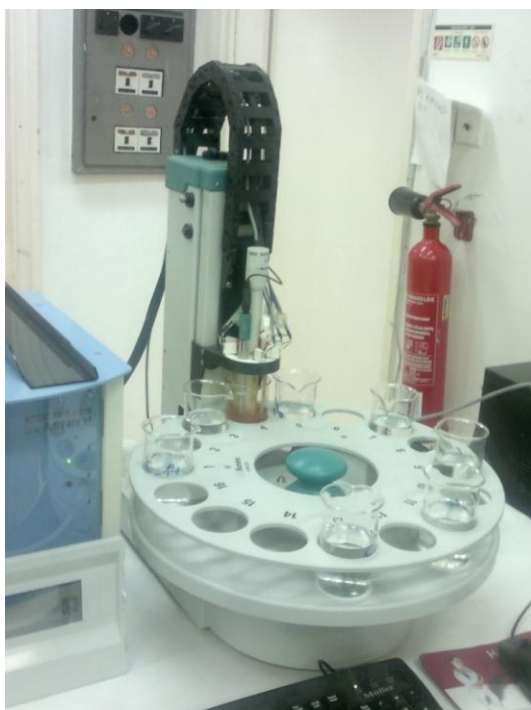
24. ábra: Elektronikus nyelv szenzorokkal ellátott egysége
