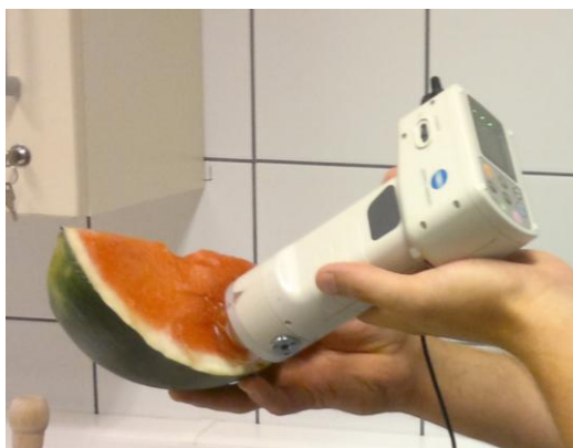
18. ábra: Konica Minolta CR 410 típusú digitális színmérő
