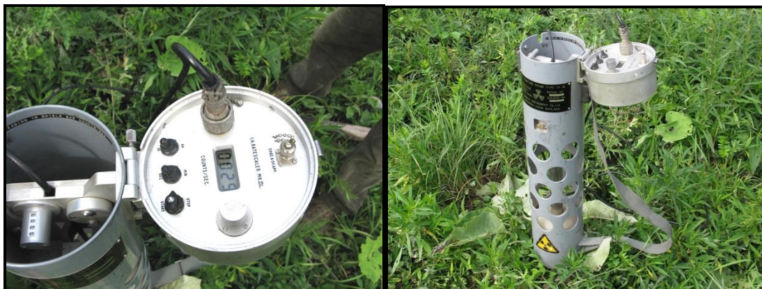
4. ábra Talajnedvesség-meghatározás neutronszerével (Forrás: Csiba, 2010)
