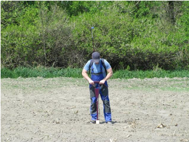
3-4. fotó. TDR-300 volumetrikus talajnedvesség-mérés
