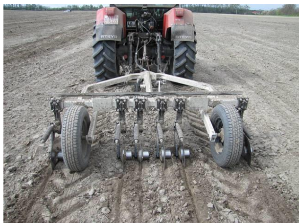
5-6. fotó. Veris 3100 talaj fajlagos elektromos vezetőképesség-mérés
