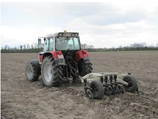
5-6. fotó. Veris 3100 talaj fajlagos elektromos vezetőképesség-mérés
