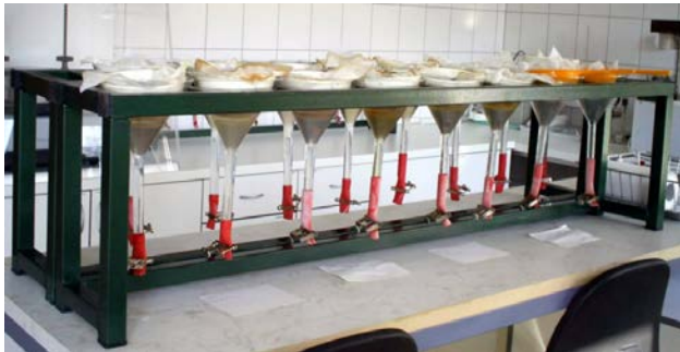
8. ábra: Laboratóriumi fonálféreg-kinyerés Baermann-tölcséres eljárással (Fotó: Tóth Á.).
