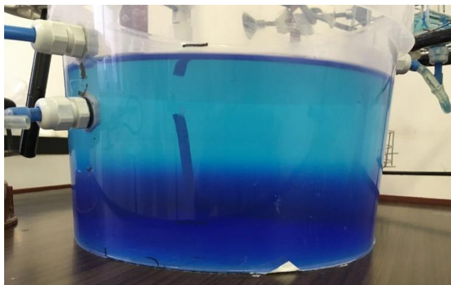
41. ábra: Rétegzett rendszer kialakítása
