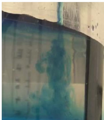
25. ábra: A belépő 1013.6 kg m -3 oldat áramlási képe
