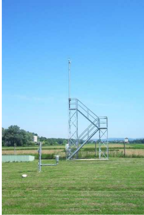
6. kép A vizsgálati területen található QLC-50 automata klímaállomás helyszíne
