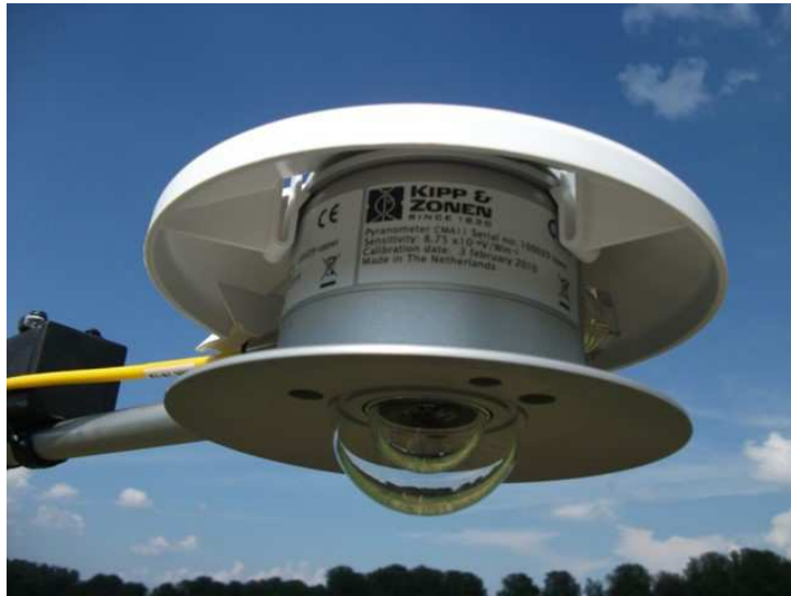
4. kép Az albedó méréséhez használt piranométer
