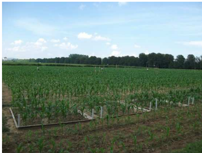
5. kép A kutatóállomáson kialakított vizsgálati terület. Parcellák és evapotranszpirométerek.
