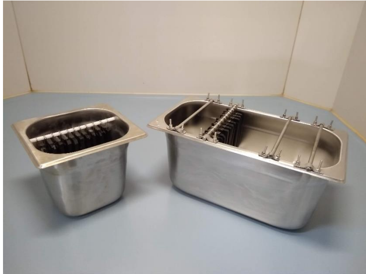
34. ábra: Az új maratórendszerben használható kádak 120 és 480 detektor maratására
