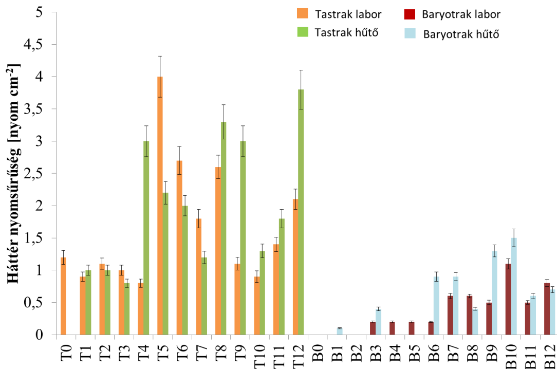
20. ábra: A két CR-39 gyártmány esetén kapott háttérnyomsűrűségek az egy éves mérési periódus alatt
