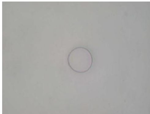
24. ábra: CO 2 lézerrel készült nyom optikai mikroszkópos felvétele
