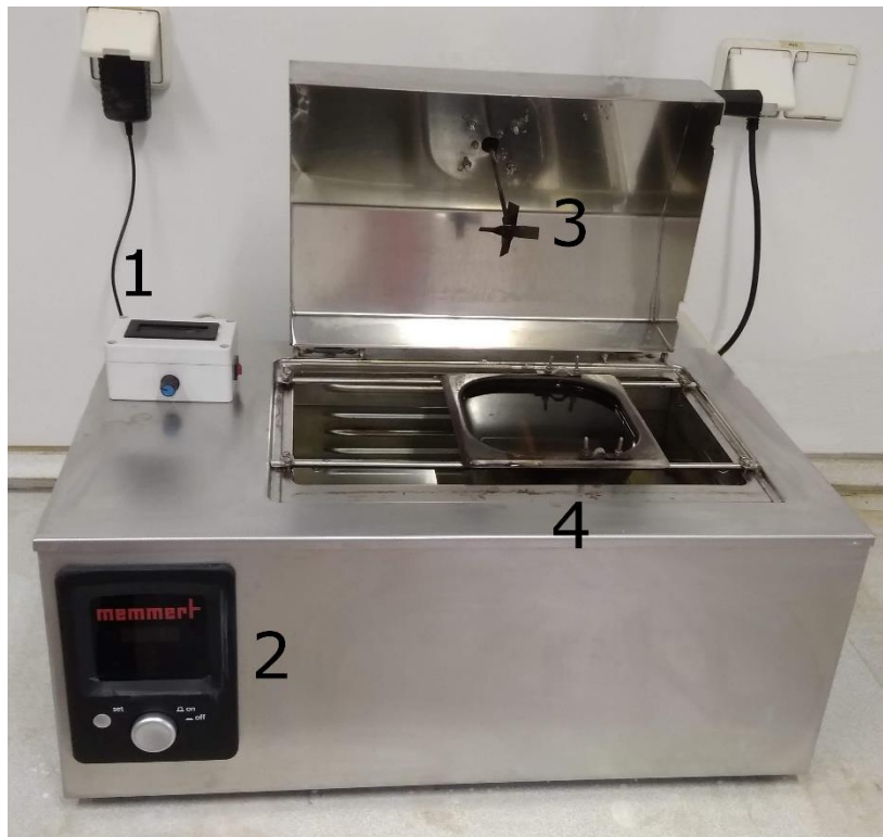
35. ábra: Az új maratórendszer (1-fordulatszám-szabályzó, 2-hőmérséklet-szabályzó, 3-keverőszár, 4-maratókád)
