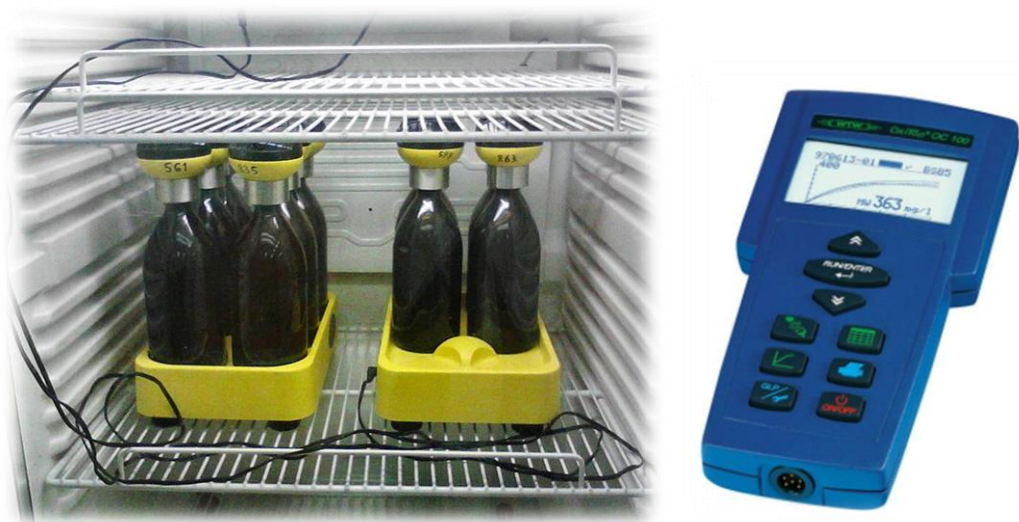
2.1. ábra: A WTW OxiTop ® Control OC 110 manometrikus gázmérő egység melyekhez tartozik egy keverőegység, fényvédett mérőedény, manometrikus mérőfejek (bal oldalt) és kontroller (jobb oldalt)
