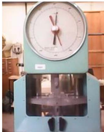
III.2. ábra: Plast-Bend-Tester hajlítószilárdság mérő műszer
