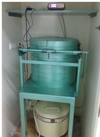
III.3. ábra: ORTEC GMX40-76 típusú HPGe ólomtoronyban, ORTEC DSPEC LF 8196 MCA-val
