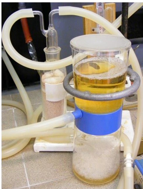
2.1. ábra: Centrifugált Xenorhabdus fermentlé szűrése
