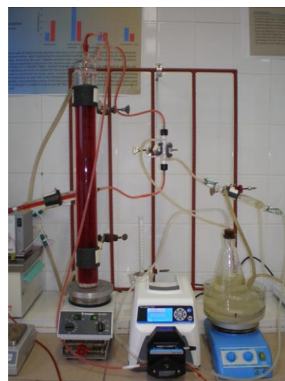
3.1.3. Ábrák: A gyümölcslevek keringtetésére és termosztálására szolgáló kísérleti berendezés
