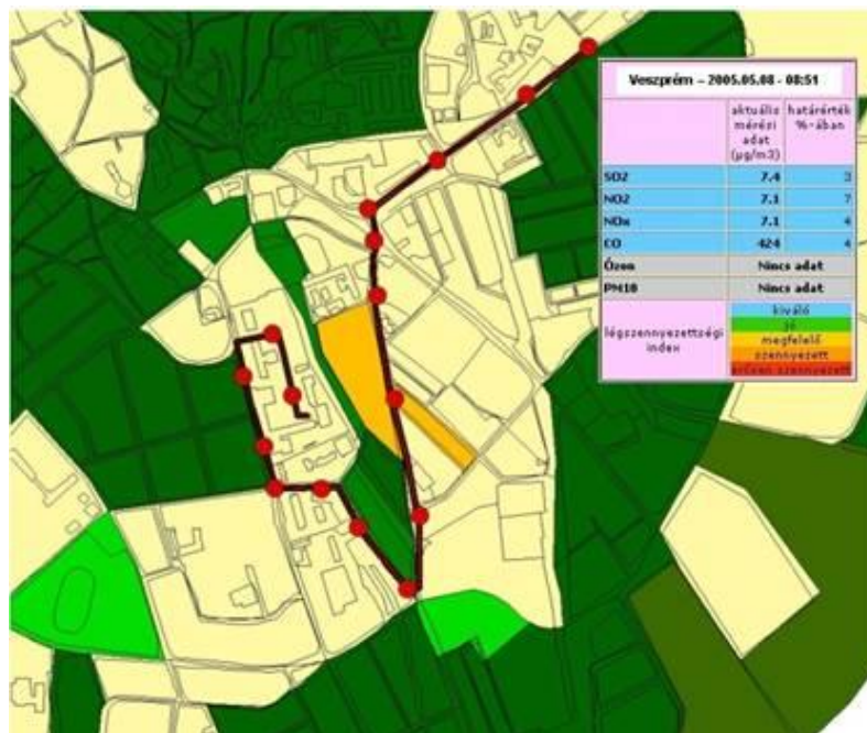
33. ábra: Dinamikus mérés – mérés a kijelölt útvonalon haladva
