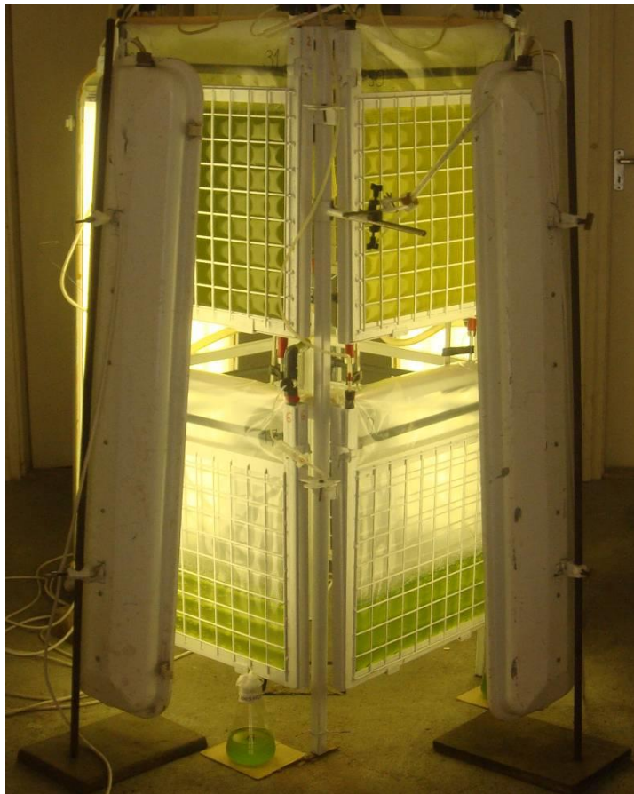
20. ábra Reaktoregység és külső fényforrásai, megvilágítása
