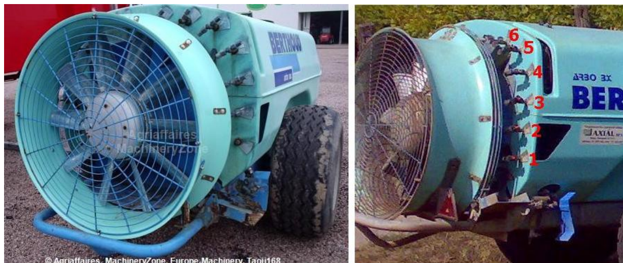
44. ábra: a) (baloldalon) a szőlőültetvényben használt Berthoud BX 1500 Arbo típusú permetezőgép, (forrás: Agriaffaires, MachineryZone, Europe-Machinery), b) (jobbaldalon) a szórófejek számozása (LÖNHÁRD et al., 2013)
