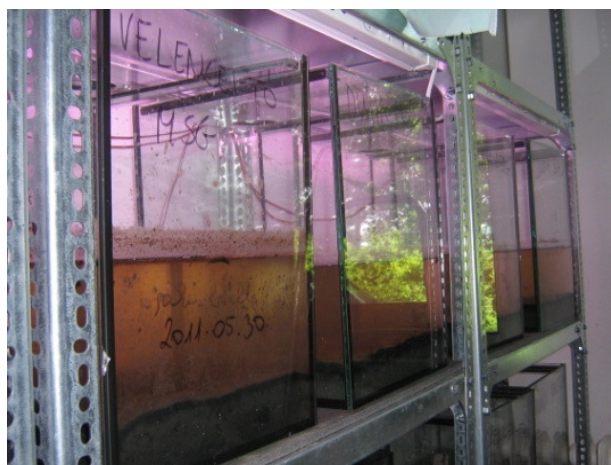
15. ábra. Beállított akváriumos kísérleti rendszer a Cry1- és Cry3 -toxinok lebomlásának vizsgálatához (fotó: Fejes Ágnes)
