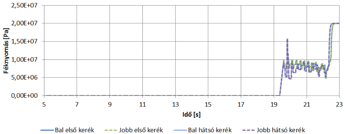
36. ábra Kerekenkénti féknymás bekapcsolt ABS ECU esetén (vészfékezés 95 km/h-ról, jól tapadó száraz aszfalt esetén)
