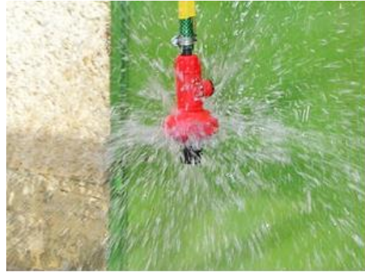
35. kép Polmac fűvóka működés közben
