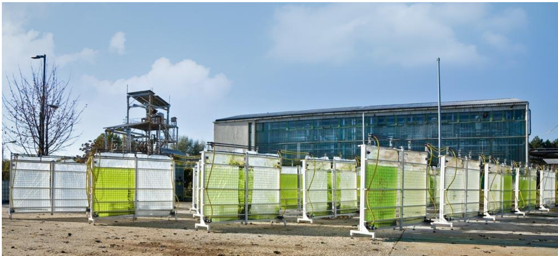
F17. Pilot foto-bioreaktorok ipari környezetben (MOL Nyrt. Dunai finomító)
