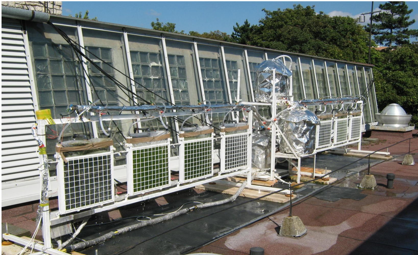
F16. Tetőn installált foto-bioreaktorok
