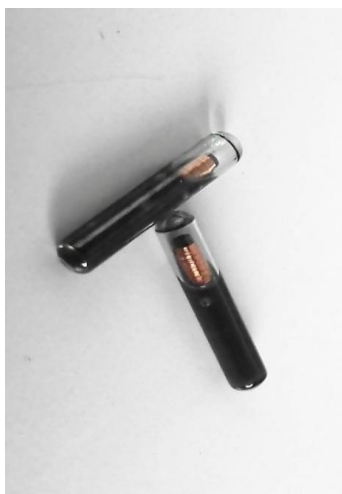
A halak egyedi jelölésére és leolvasására szolgáló AEG ARE-H5 készülécsomag és a hozzá tartozó mikrochipek (PIT)
