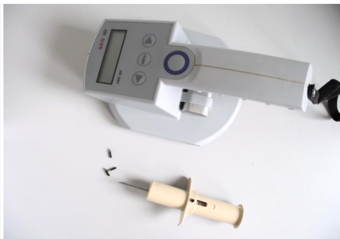
A halak egyedi jelölésére és leolvasására szolgáló AEG ARE-H5 készülécsomag és a hozzá tartozó mikrochipek (PIT)
