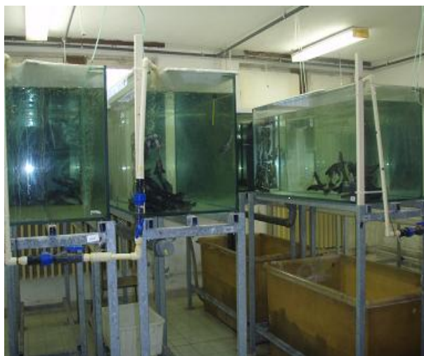
A kísérletekhez használt akváriumos, recirkulációs rendszer
