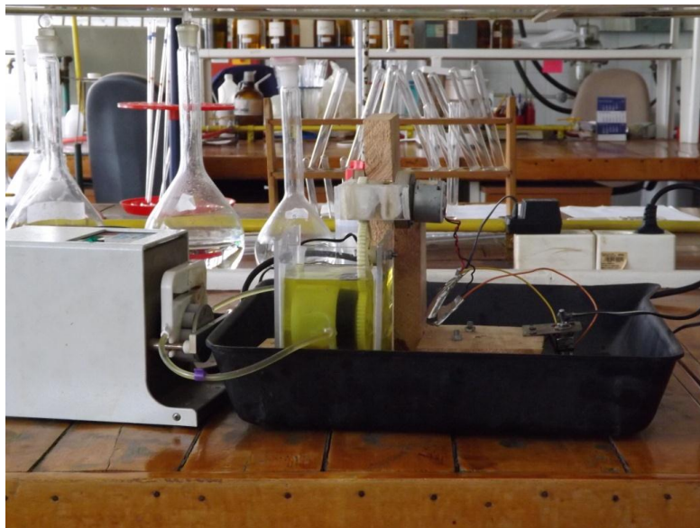
8. ábra A modellezett forgódobos oldó reaktor
