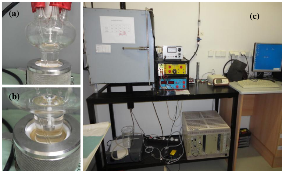
24. ábra A radioelektrokémiai mérőrendszer fényképe (a) mérőcella az oldattal és a meniszkusz pozícióban lévő elektróddal (b) az elektród helyzete felemelt pozícióban (c) „sötétlabor” a kombinált nukleáris és elektrokémiai mérésekhez.
