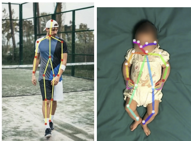
4.1. Ábra: Ezen a képen OpenPose nevű pózbecslő eljárás eredményét láthatjuk. Baloldalt egy felnőttre adott eredmény. Jobboldalt pedig csecsemőre adott eredmény látható.
