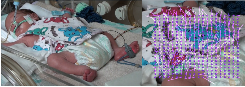
5.1. Ábra: Egy példa a ritka optikai áramlás esetén követett pontok elhelyezkedésére. A követett képpontok egy szabályos rácson helyezkednek el. A pontokból kiinduló vonalak mutatják a követett pontok mozgásának irányát.
