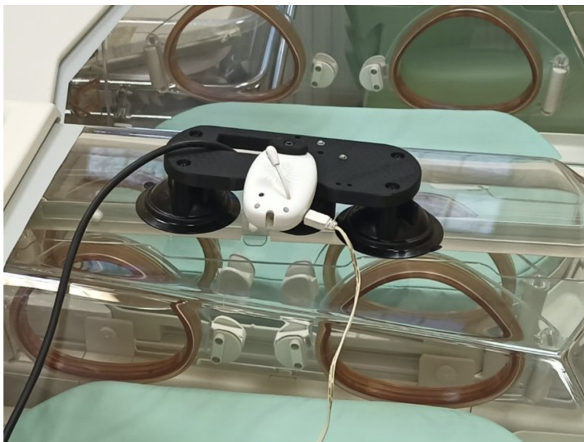
3.3. Ábra: A 3D nyomtatott burkolattal rendelkező adatgyűjtő rendszer, amely tartalmaz egy kamerát, egy infravörös megvilágítót és az ezek vezérlésére alkalmas Raspberry Pi-t. A bemutatott rendszer alkalmas volt akár egész napos felvételek elkészítésére is.
