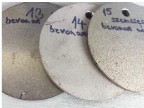
14. ábra: S40MC acéllemezek felülete a különböző mechanikai felület-előkezelések után
