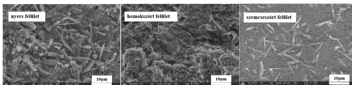
36. ábra: Szóró eljárásban a különböző felületeken kialakult cinkfoszfát réteg struktúrája
