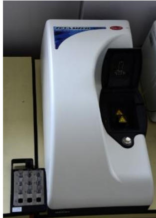
6. ábra: Malvern NanoZS készülék részecskeméret meghatározáshoz
