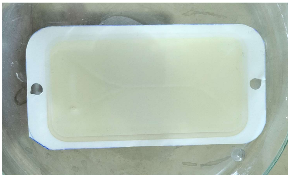
39. ábra Enzimakatalitikus membrán EMBR-ben végzett diklofenák átalakítás után.
