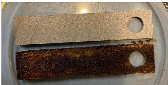
4.10. ábra. Korróziós próbatest a vizsgálat előtt és után.
