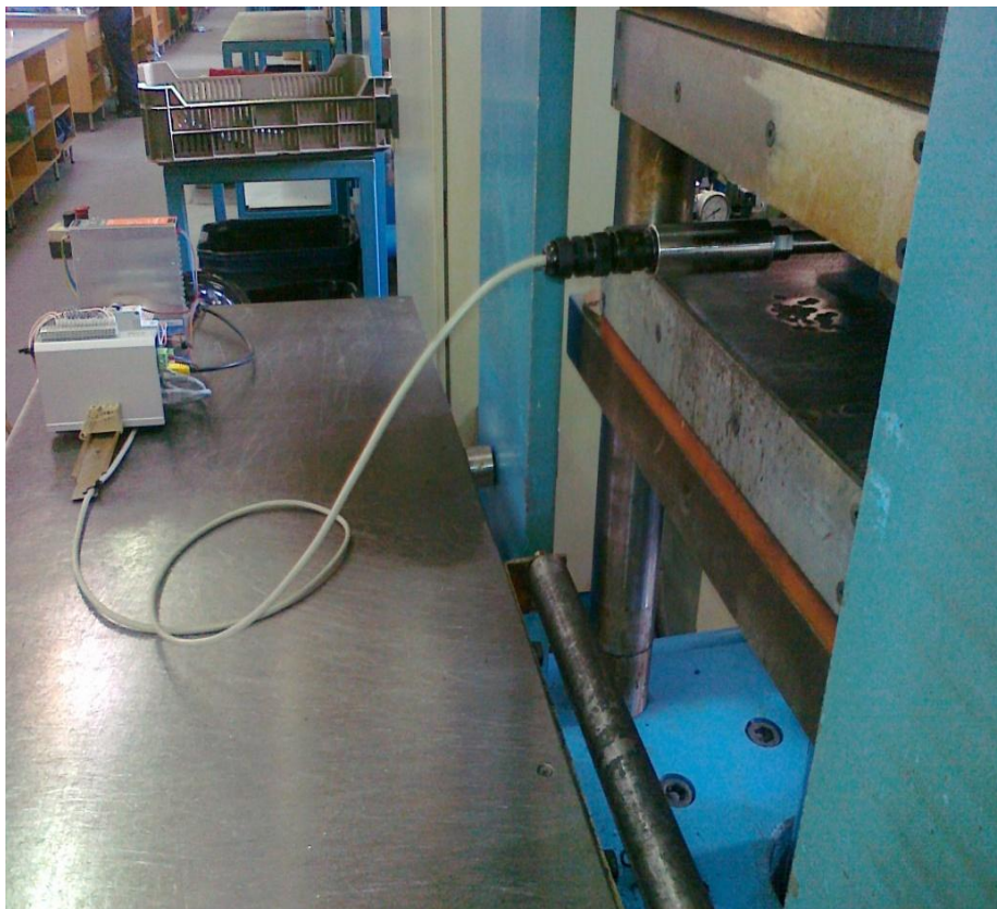
62. ábra. A préstechnológiával végzett szerszámüregi nyomásmérés
