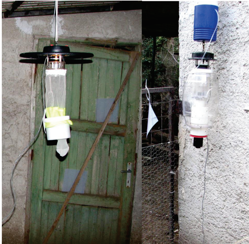
10. ábra CDC Miniature Light trap fénycsapda (balra) és MMX csapda (jobbra) egy baromfiudvarban.
