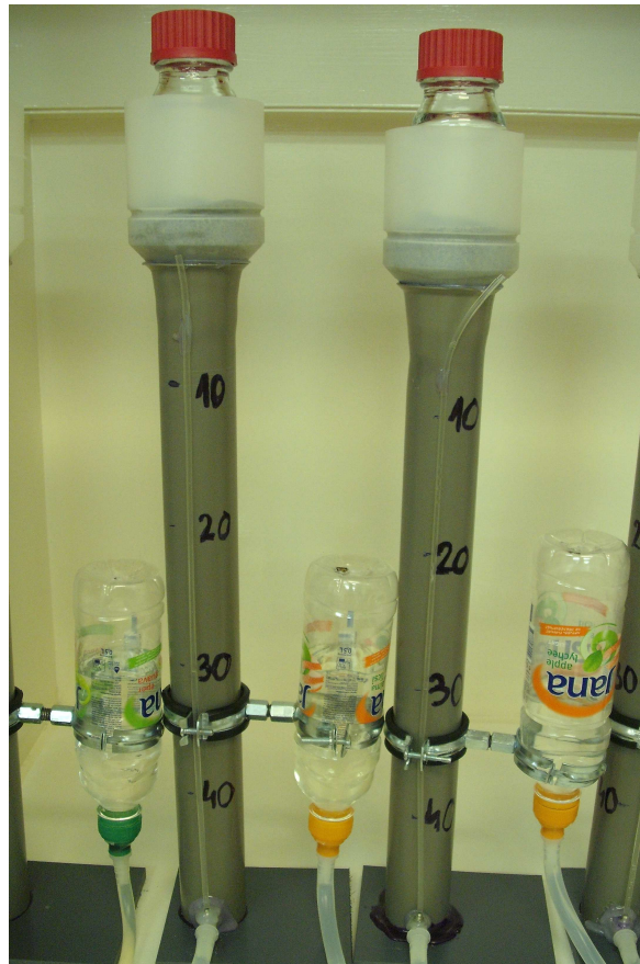
3.2.4.C ábra Mikrokozmoszok inkubálása -30 kPa vízpotenciálú oszlopon (oldalnézet)
