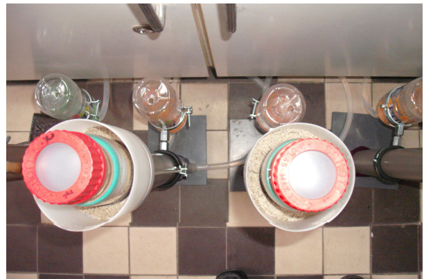
3.2.4.B ábra Mikrokozmoszok inkubálása -10 kPa vízpotenciálú oszlopon (felülnézet)
