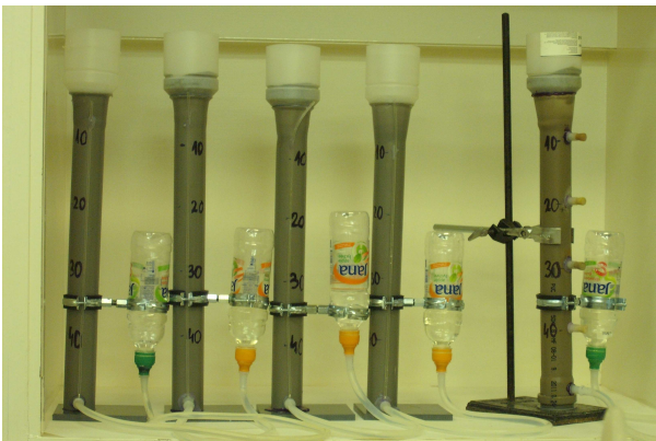
3.2.4.A ábra Talajminták különböző víztartalmának beállítására alkalmas eszközrendszer
