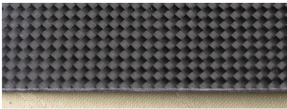
3.1. ábra Nyolcrétegű textil kompozit lemez
