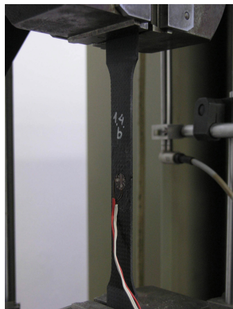
8.20. ábra Nyíró próbatest a vizsgálat előtt
