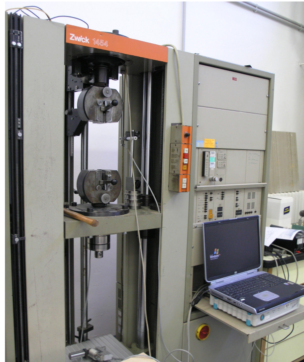
8.5. ábra Az anyagvizsgáló rendszer
