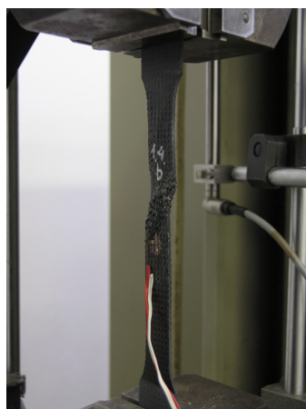
8.21. ábra Nyíró próbatest a tönkremenetel után
