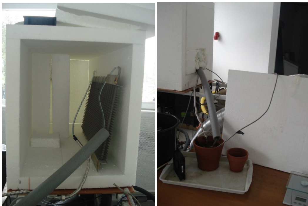
3.12. ábra Szigetelt doboz belső hőcserélővel (bal oldali kép) és hűtött víz keringtetése egyenáramú szivattyú segítségével (jobb oldali kép) (SZIE)
