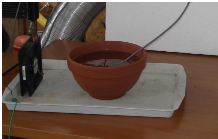
3.8. ábra Nyitott agyagedény víztartalmának párolgatótása ventilátorral (SZIE)
