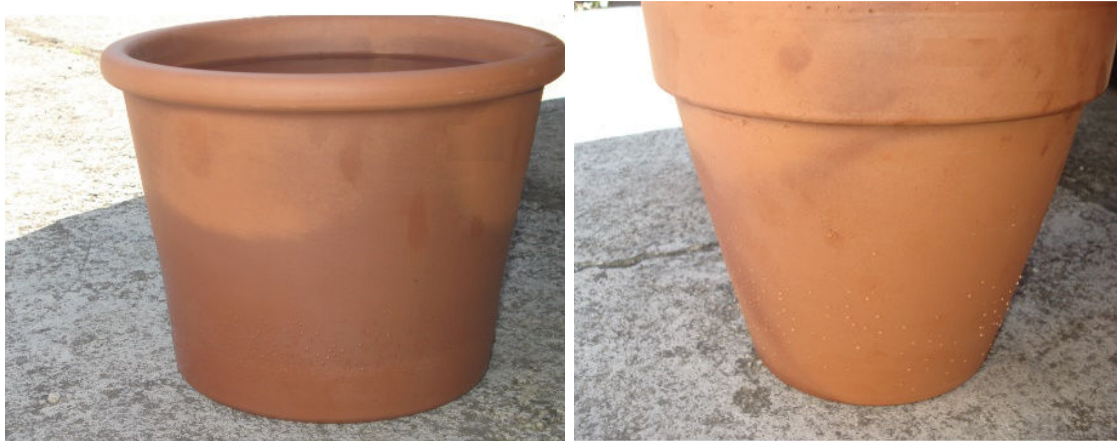
4.21. ábra Kerámia edények vízzel töltve (bal oldali kép: átnedvesedett fal, jobb oldali kép: kerámiaedény oldalán vízcseppek)
