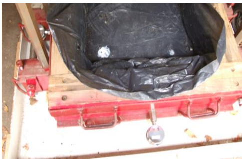
3.14. ábra A csurgalékvíz elvezetése, összegyűjtése
