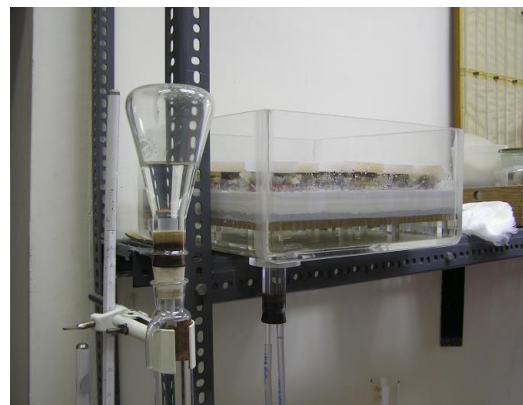
3.30. ábra Homoklapos berendezés működés közben
