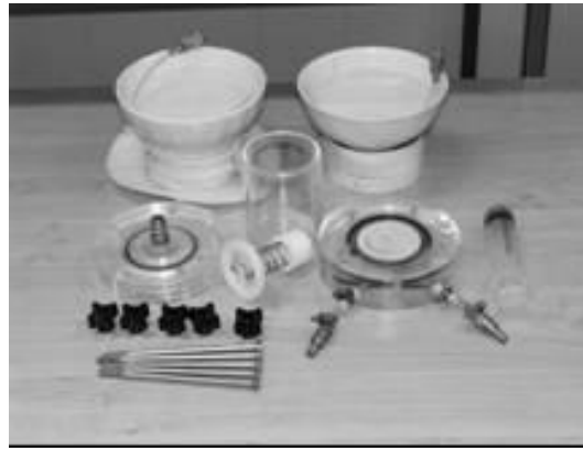
3.28. ábra Feszültségkamrás alapkészülék szétszerelt állapotban
