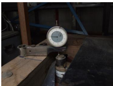
a) a függőleges összenyomódás mérése
