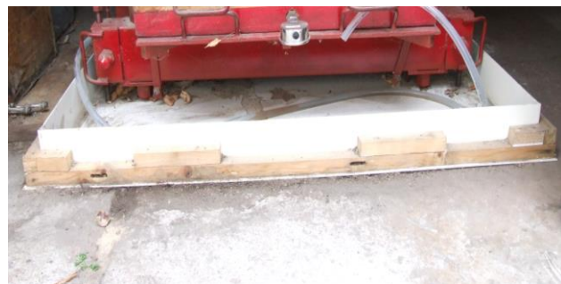
3.14. ábra A csurgalékvíz elvezetése, összegyűjtése
