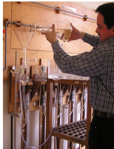
3.6. ábra MTA-TAKI víztartási görbe mérése
