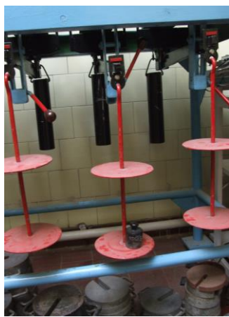
a) a minta bekészítés és simító terhelése
