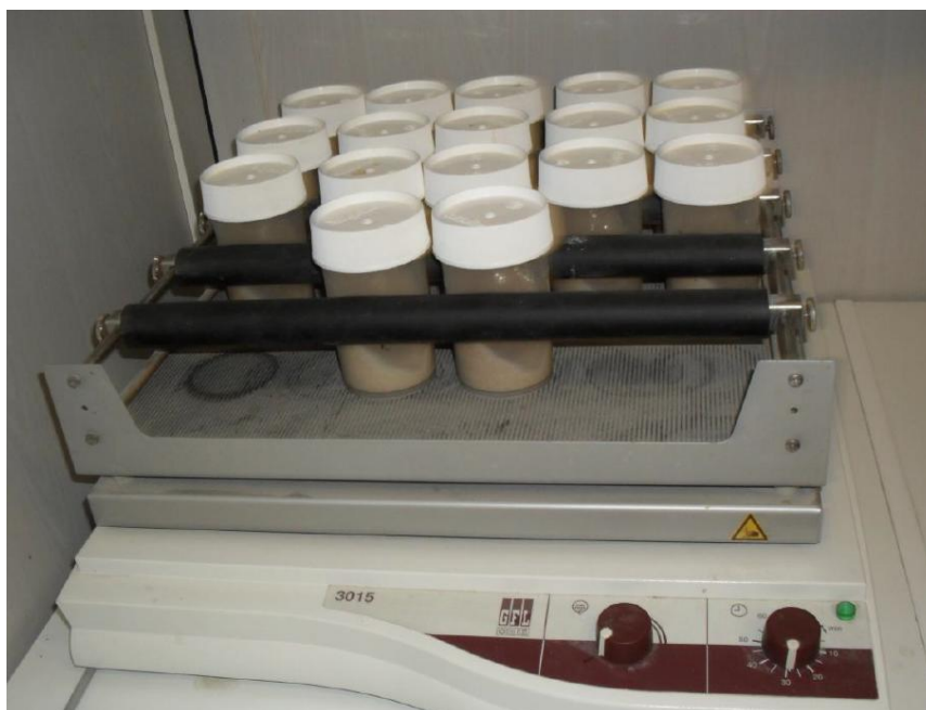
3.7. ábra A búzaőrlemény desztillált vizes oldatának rázógépen történő kioldása
